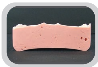
Alginate Mixed Manually / Alginatmischung händisch
